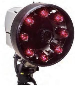
FlawExplorer传感器单元，带有四个或八个激光二极管，可一次性检测最大2m<sup>2</sup>（20平方英尺）的区域
