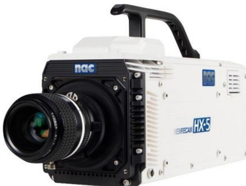
**Memrecam HX-5E 拥有高端的 500 万像素，并在该满幅分辨率下帧速达 1370 帧/秒，全高清像素下帧速达 3210 帧/秒，100 万像素下达 6340 帧/秒。HX-5E 为用户的需求提供了最好的解决方案：最高分辨率，最高感光度及超快拍摄速度。**
